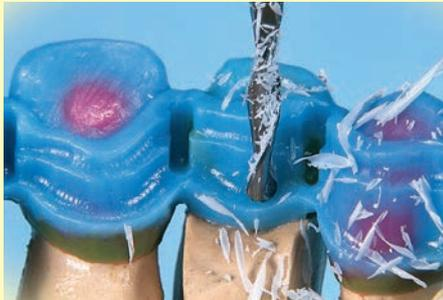
Cera de fresado con excelentes características para fresar y modelar. Buena característica de raspado y fresado al no quedar virutas pegadas en la fresa de fresado.
