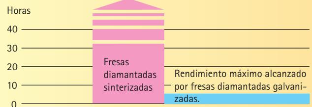
Conclusión: Comparando las fresas diamantadas sinterizadas y las galvanizadas, han destacado en la prueba de larga duración las Diabolo de brendent por su eficacia y su larga vida útil. Gracias al autoafilado de los cristales de diamante, las fresas diamantadas sinterizadas siguen cortando hasta el final, consiguiendo un gran rendimiento en el desbaste del material.
