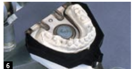
6 Montaje en el articulador: con el sistema magnético, ACCU-TRAC se fija al articulador de forma fácil y segura.
